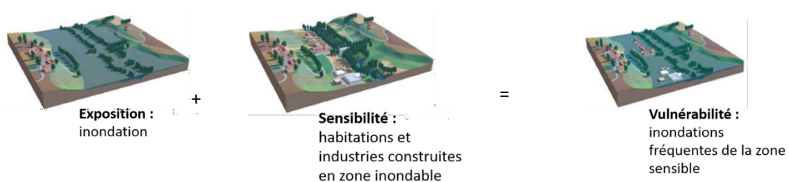
Figure 1 : Notion de vulnérabilité - Source : Les inondations, Ministère de l'écologie et du développement Durable, 2004
